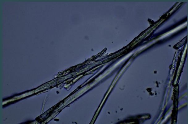
Algodón mercerizado vista lateral y trasversal
